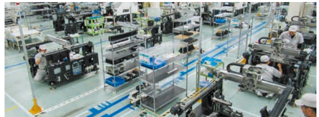
AGVを活用したタクトコントロール生産(JUKI産機テクノロジー)
