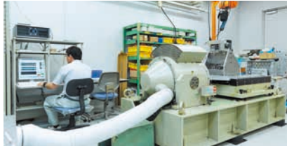
加振機を活用しての振動試験
