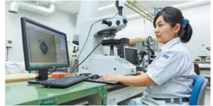
ビッカース硬度計での硬さ試験
