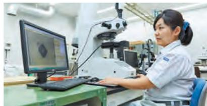
ピッカース硬度計での硬さ試験
