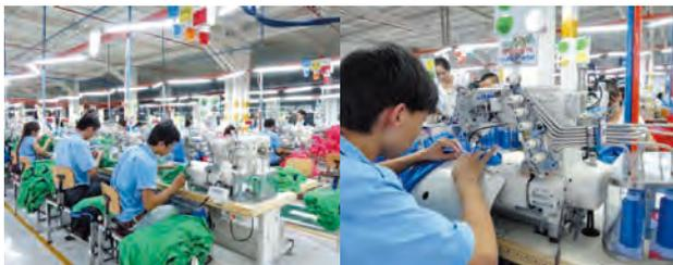
“決められた時間に決められた数量を良い品質で”、全社員の合言葉です。生地送り安定化のための補助テーブルの設置やエアコンの送風を避け、糸の繰り出しを安定させるために糸ボックスを全てのミシンに取り付けるなど、TMI社の現場には、さまざまな独自の工夫がされています。
