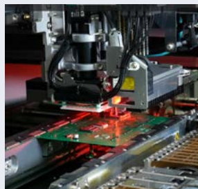
XL基板に対応した新モデル 高速スマートモジュラーマウント「RS-2」
