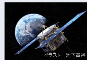
イラスト 池下章裕 衛星の金色部分がMLI
