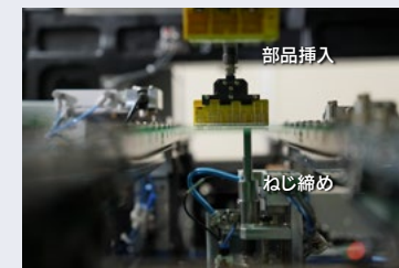
大型・異形部品の挿入とねじ締めの「2工程1台完結」を実現するマルチタスクプラットフォーム「JM-E01」
