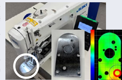
針板部品 AIが予測した補正位置
