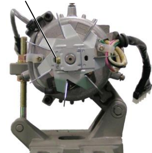
図3 モータ冷却用ファン取付ねじ
