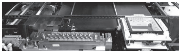
図11 匠ヘッド用のオートツールチェンジャーとVCSユニット
