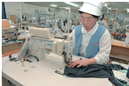
BSファインを使ったアウター用シャツの縫製。通常の繊維と同様に縫製作業が出来る。
