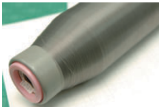
ブラックシリカをポリエステルに練りこんだ糸。これを織って繊維BSファインを作る。
