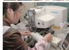
高速電子単環根巻きボタン付けマシンAMB-289。このほかにも、ポケットセッター、鳩目穴かがり、眠り穴かがりミンなどもある。13名という規模にしてはミンは豊富だ。
