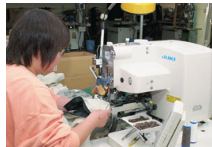
すくい縫、シャンクボタン、マーブルボタン、カボタン付けが可能で、4つ穴ボタンでも手縫い風の品質を実現。ボタンローダーも標準装備して、日産1600-2000個と生産性も高い
