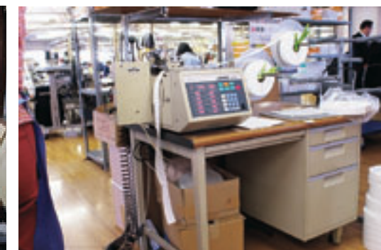
JUKI製のポケットセッターなどと並んで、テープカッターも使われている
