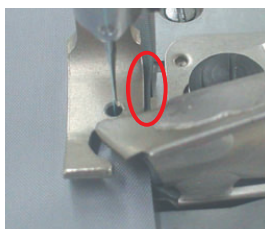
バインダー出口定規部を押しさえに隙間なく取り付ける
