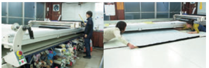
狭い裁断スペースを有効に活用するため、延反台を浮かして、隣の延反台からスライドさせて生地を移動できるように工夫されている。
