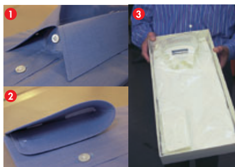
衿ステッチは、通常13-16針/3のところを同社では22針/3で縫う。カフは外周差を考慮して内側に湾曲するように作られている。着心地は1つまでもない。折りたたみも表にしわが出ないように、シャツに合わせて工夫している。
