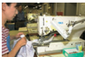
高速電子眠り穴かがりマシンLBH - 1790。カフと前立専用2台が導入されている。すぐ横でLBH-791がボタンダウン用に使われている。
