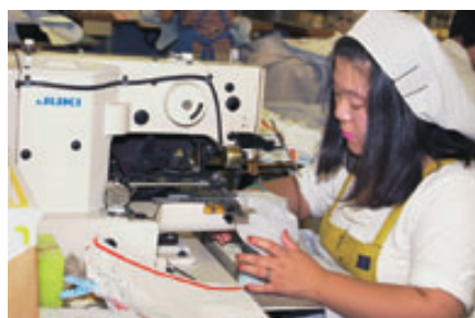
ボタン付けはLK-1903。サイズやデザインが全部違うので、インデキサーは使用できない。一つずつボタンをつけてゆく。
