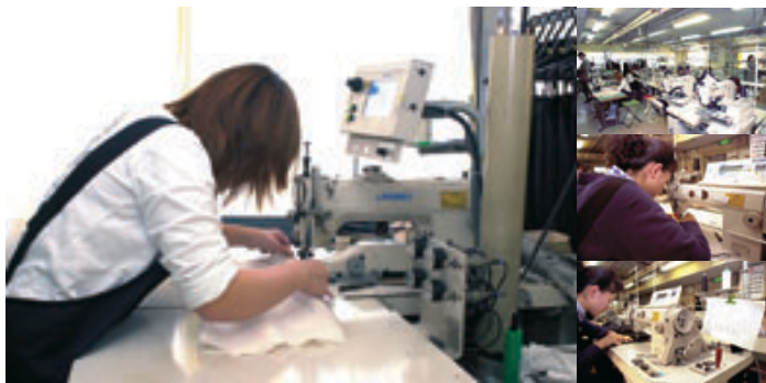
本社工場ではボトムを担当する。岩手工場が受注したスーツのボトムを作ることも多い。裁断後の生地が送られてきて仕上げ、岩手工場に戻ってセットにされる。ミシンの横には工程分析表と作業指示書が掲示され、生産数、タクトタイムなどのデータが記されている。
