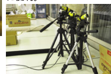
カメラ用の三脚を利用して作ったレーザーマーカ。簡単に持ち運びできて、非常に便利。
