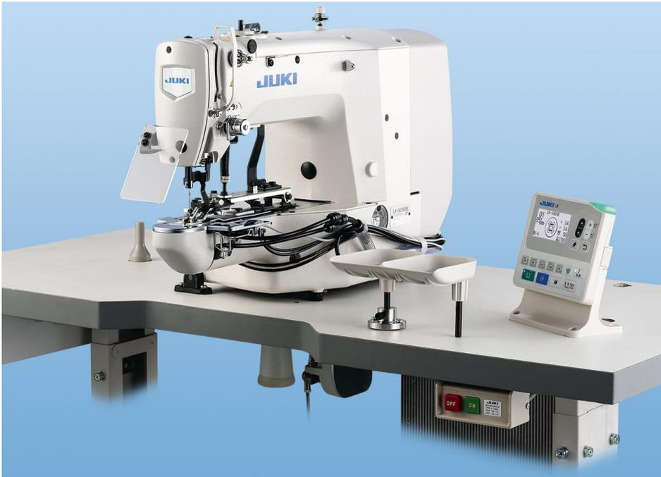
JUKIは、高速電子本縫いボタン付けマシンLK-1903B(2014年1月発売)に、「鳥の巣防止、残短仕様」の2つの新機能を搭載したサブクラス機を11月より国内外で発売します。両機能の搭載は、世界初となります。
