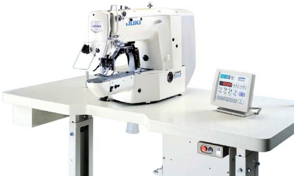
JUKIは、世界最高クラスの縫い速度3,200sti/minを実現した高速電子罅止めマシン「LK-1900ANシリーズ」を1月11日より発売します。当機は、2003年6月より発売を開始したLK-1900Aシリーズのモデルチェンジ機で、世界最高クラスの縫い速度を実現し、生産性が大幅に向上しました。また、音・振動の低減などにより、オペレーターへの負担を軽減したマシンです。
