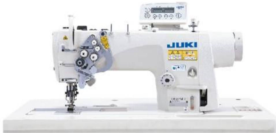
JUKIは、小型サーボモーターをミシンの上軸に直結させた「ダイレクトドライブ」機構のセミドライヘッド2本針本縫ミシン「LH-3500Aシリーズ」を1月11日より発売いたします。当機は、2007年7月より発売を開始したLH-3500シリーズのモデルチェンジ機で、ダイレクトドライブ機構の採用により、縫い品質の向上とともに、省エネ性・作業性・針の貫通力を向上させました。
