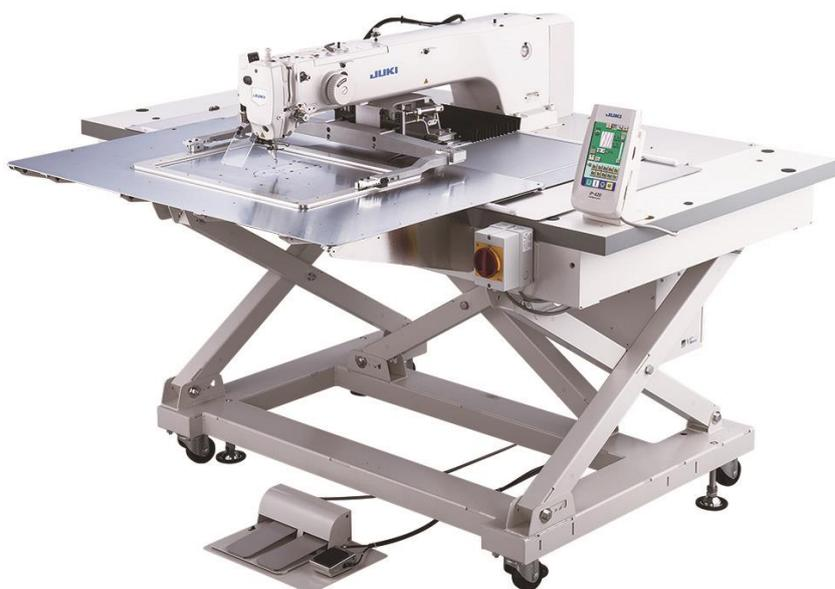
JUKIは、下糸を自動で供給する機能で、生産を中断させていたボビン交換作業をなくし生産性を向上できる、入力機能付き電子サイクルマシン(全回転釜仕様、下糸自動供給装置付き)「AMS-224EN4530R/AW-3」を、国内は3月21日より、海外は4月21日より発売します。
