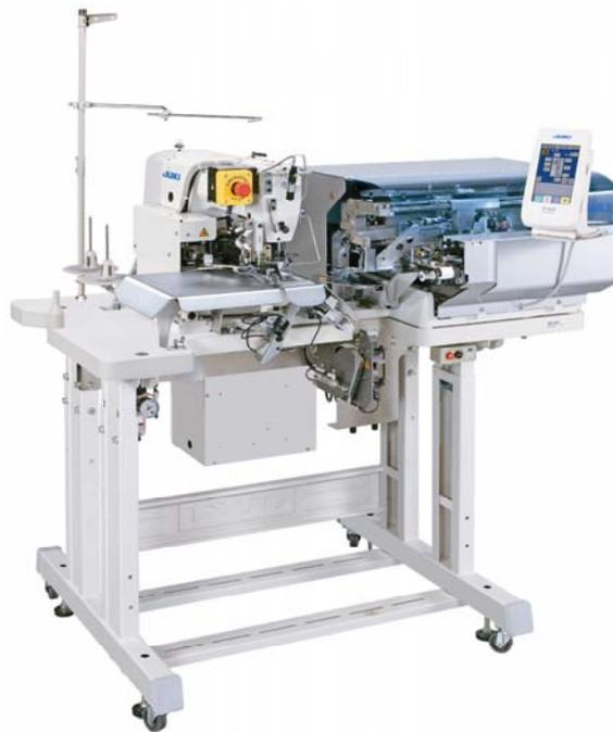
JUKIは、スラックス・カジュアルパンツのベルトループ付け縫製に最適で、7種類の縫製パターンを内蔵し、フレキシブルに多様なベルトループ付けに対応できる自動機、「1本針自動ベルトループ付けマシン AB-1351」を3月1日から発売いたします。
