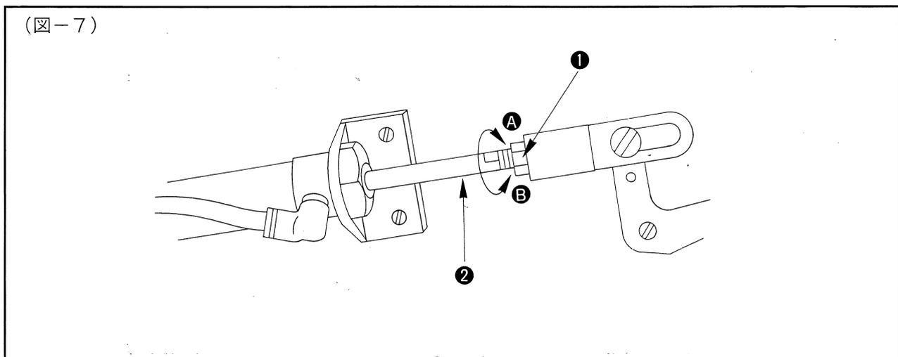
シリンダを全圧縮させた時、押え外足の上昇量が20mmになるように、調整ナット①をゆるめてシリンダロッド②を回し調整してください。
