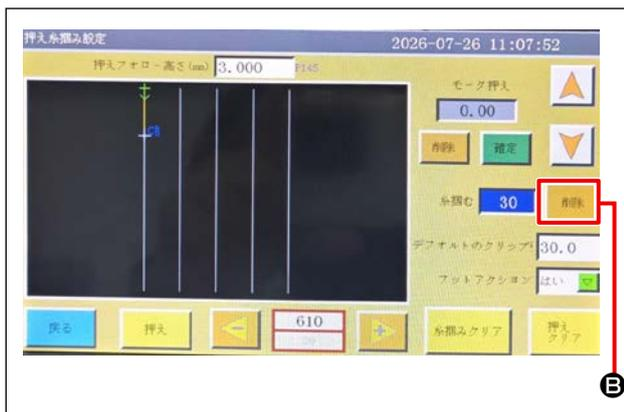
2) 個別の張力設定を削除する場合、十字マーク (+) を設定位置に移動して、削除ボタン **B** を押します。
