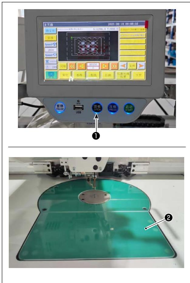
1) ミシンの電源が入っている状態で、スイッチ①を押します。
