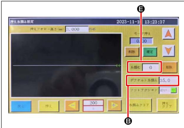
6) 手順 2) と同様に押え、糸つかみ張力の設定画面に入り、手順 3) で確認した糸つかみ張力設定値を糸つかみ **E** に入力します。デフォルト糸つかみ **B** を「1」に設定します。
