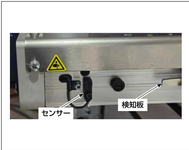
3) X 送り原点検知センサーと検知板のすき間を
