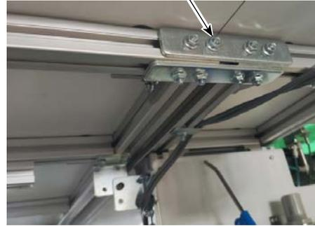
2) 各部は専用リンク板①とナットで固定します。
