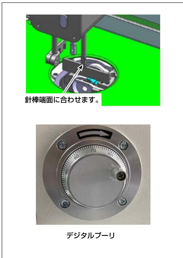
2) 針板を外して、デジタルプーリを回して、針棒下死点をタイミングゲージで確認してください。合わない場合はP 36の調整方法を参照してください。
