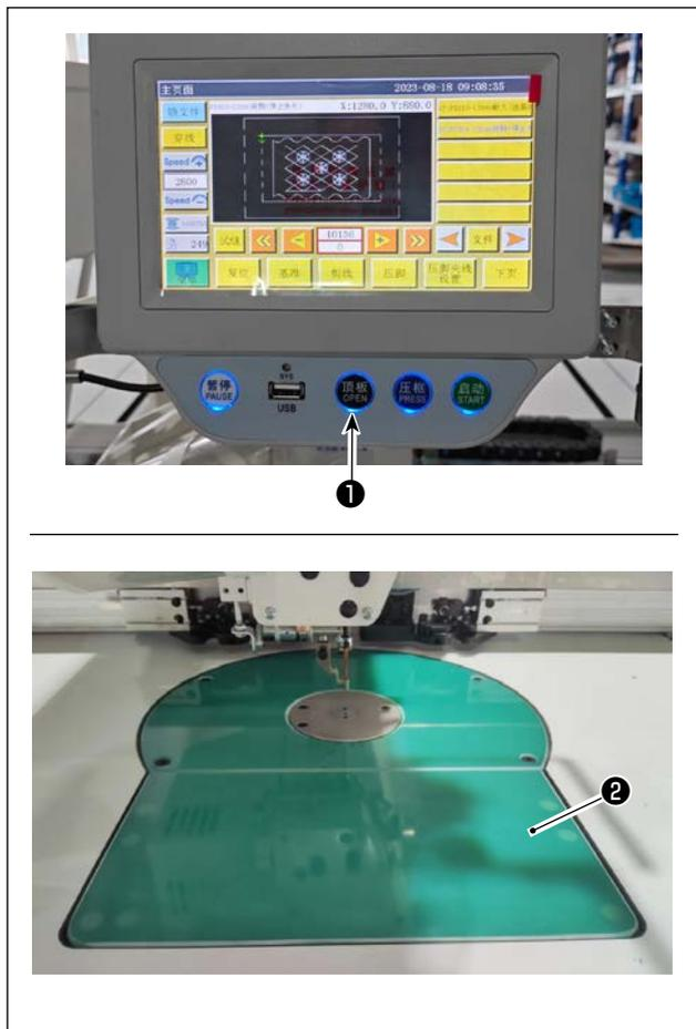
1) 在缝纫机电源打开的状态下，按下开关**①**。
