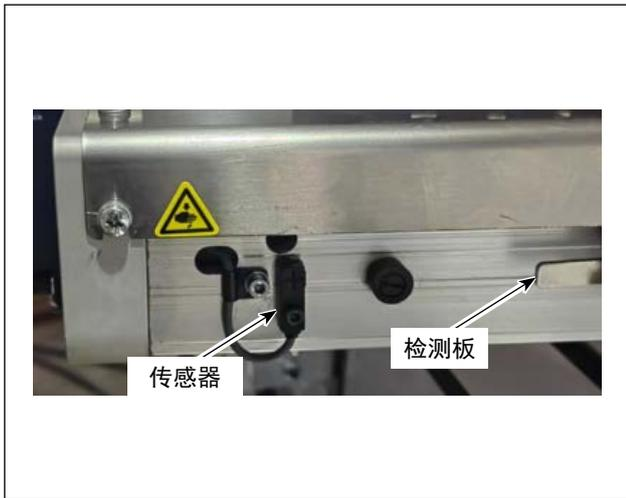
3) 检查 X 送料原点检知传感器和传感器检知板的间隙。
