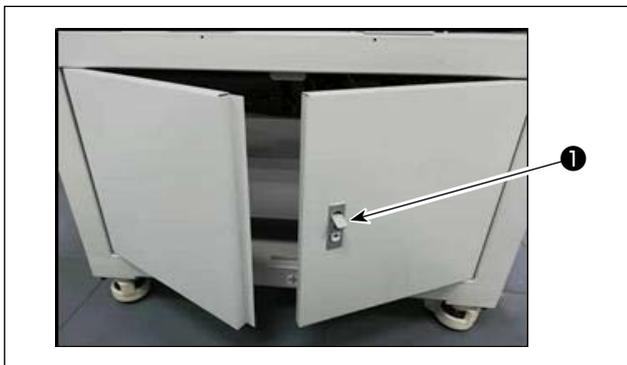
1) 缝纫机背面或侧面的门的锁①解锁后打开。
