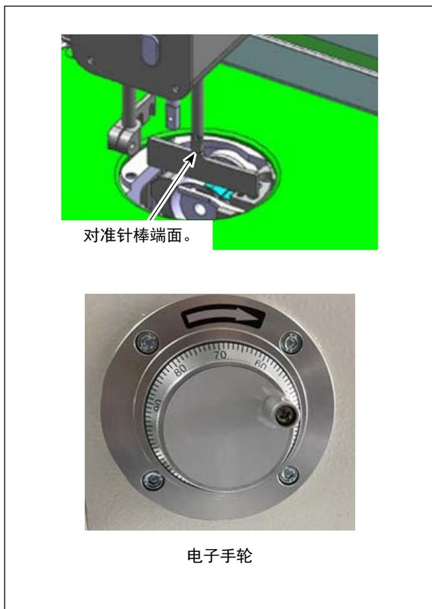
2) 拆下针板，转动电子手轮，用针杆治具确认针杆下死点。
