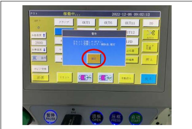
⑤ 缝纫机面板上显示提示，请按下“确定”。
