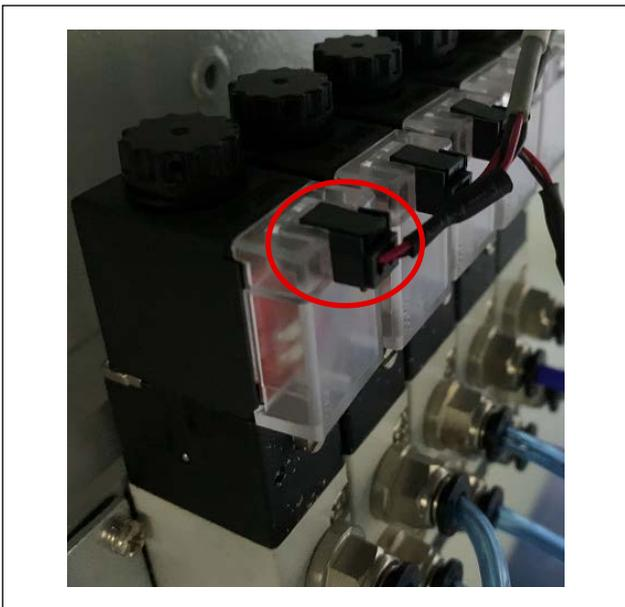
1) 请在 "1-8. 组装空气软管" p. 24 中安装的电磁阀上连接 BK10\_SOLENOID VALVE\_CABLE\_ASSY 的连接器。
