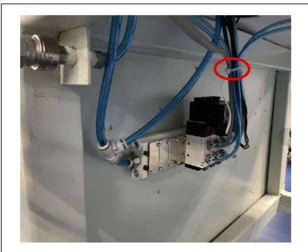
2) 请用束线带将 BK10\_SOLENOID VALVE\_CABLE\_ASSY 与其他空气配管合并。
