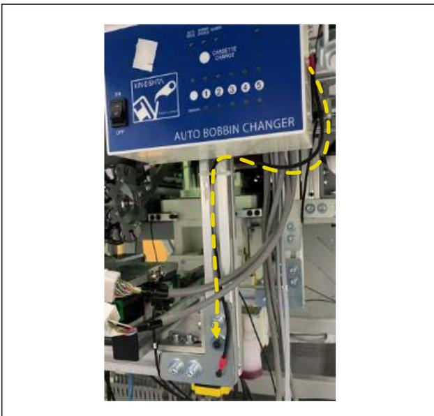
2) 按照图示把接地线敷设配线，用螺丝把圆形端子拧紧到缝纫机框上。
