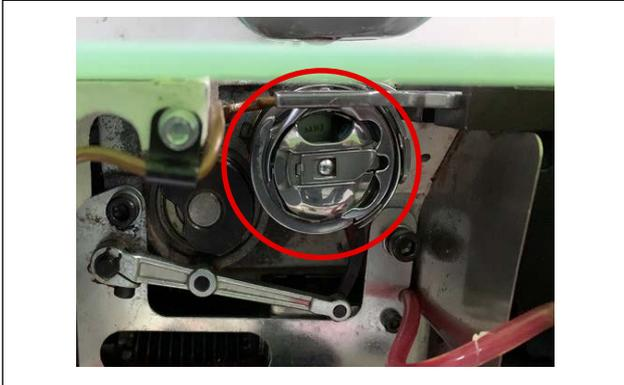
② 设置在缝纫机一侧的梭芯，请以手动进行交换。
