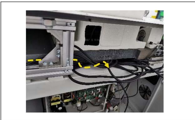
5) 请按图示的路径敷设配线，并拉进电装内部。
