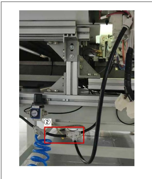
② 从BK-10配管的空气软管（100mm：1根）和T型组合，请如图所示进行连接。
