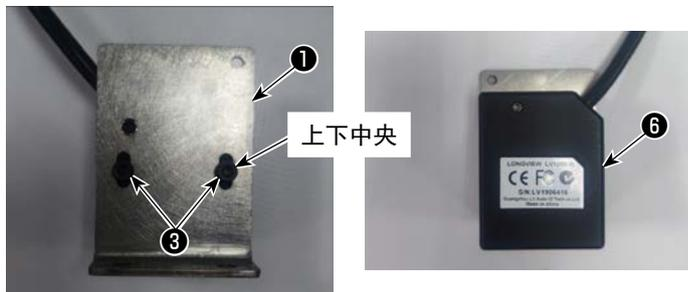
1) 用螺栓③固定条形码阅读器⑥和安装板①。
