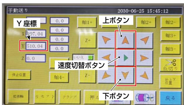
3) 「上ボタン」「下ボタン」を押して Y 座標 : 820 の位置まで Y 軸を移動させます。なお、「速度切替ボタン」により移動速度を調整することも可能です。
