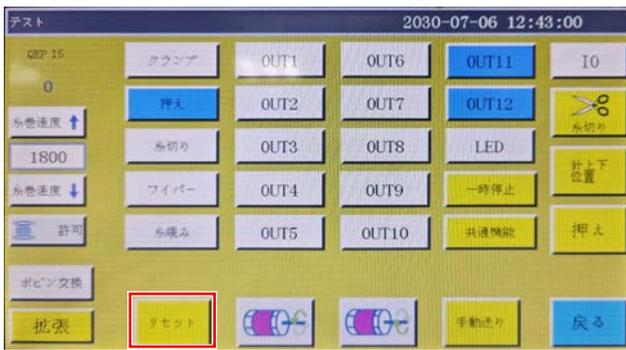
5) 問題がないことを確認したら、「リセット」ボタンを押して、装置が順番に先にワイパーを戻して糸保持を閉じるかどうかを確認します。そうでなければ、「プログラミングファイル」が正しく導入されているかどうかをチェックします。
