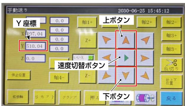
3) 「上ボタン」「下ボタン」を押してY座標：510の位置までY軸を移動させます。
