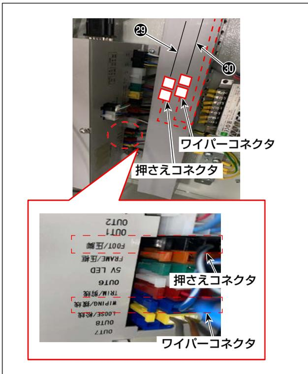
1) 押さえコネクタ (黒色 /2pin) を電装から外し、上系クランプ中継線 B ㉙のコネクタに接続します。
