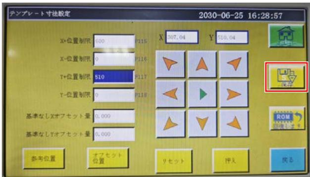
12) 「保存」を押した後、「確認」を押すと、このとき Y 方向の縫製範囲は 820 mm に変更されます。
