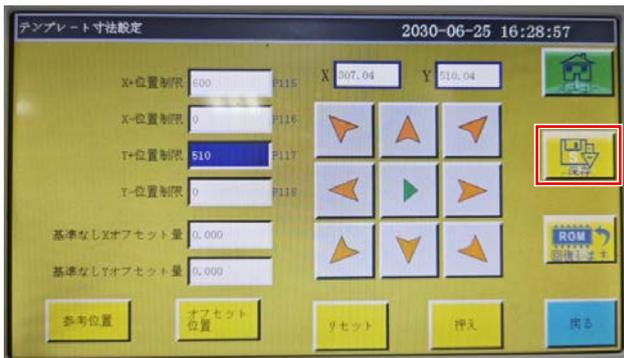
12) 「保存」 を押した後、「確認」 を押すと、このとき Y 方向の縫製範囲は 510 mm に変更されます。
