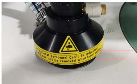
罩壳距离台板位置或工作模板下压时 8mm 以下
