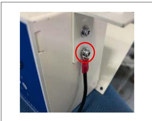
1) BK コントロールボックスに接地線をねじ止めします。
