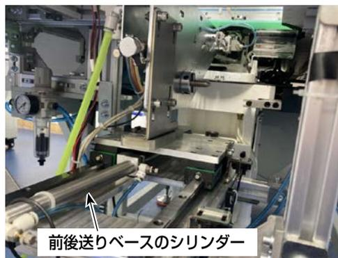
4) アームヘッド先端とマシン釜側のボビンケース表面を合わせるため、前後送りベースの固定位置を修正します。
