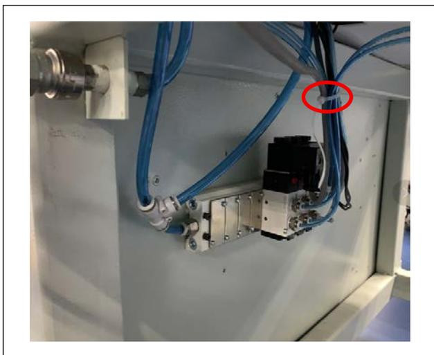
2) BK10\_SOLENOID VALVE\_CABLE\_ASSY は束線バンドで他のエア配管と合わせてまとめてください。
