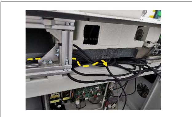
5) 図示の経路で配線して電装内部へ引き入れてください。
