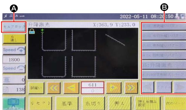
1) ボタン **A** を押し、パターン変換をロックします。
