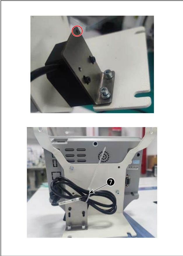
4) バーコードリーダ取付板のこの穴に束線バンド⑦を通し,パネルの後ろにケーブルを固定します。
