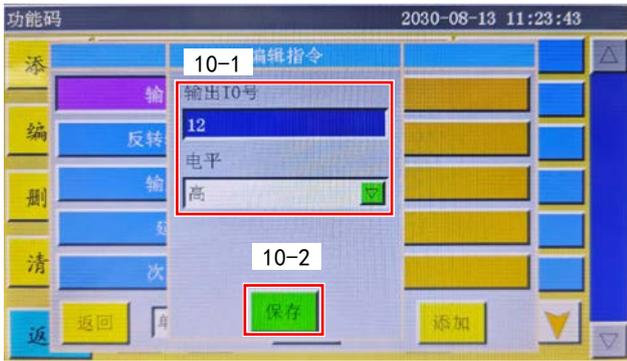
10-1) 在“输出 IO”上输入“12”，在“水平”上输入“高”。
