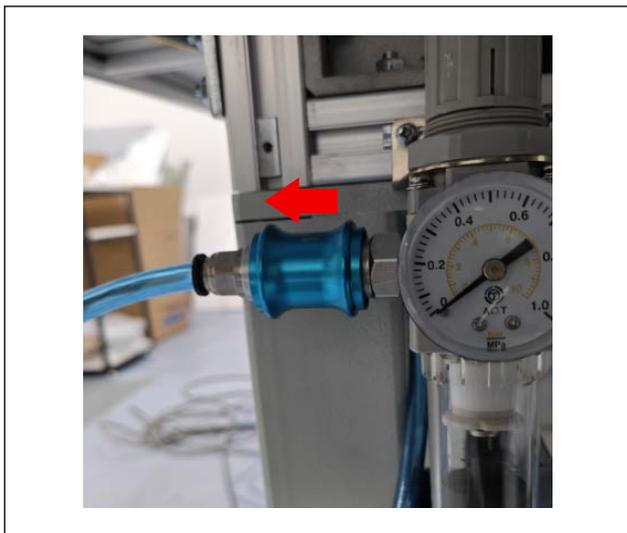
1) 向左推空气旋塞，切断缝纫机的空气。
