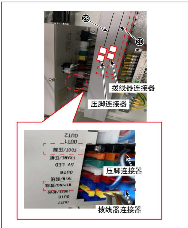
1) 从电装上拆下压脚连接器（黑色 /2pin），连接至上线夹中继线 B 29 的连接器。
