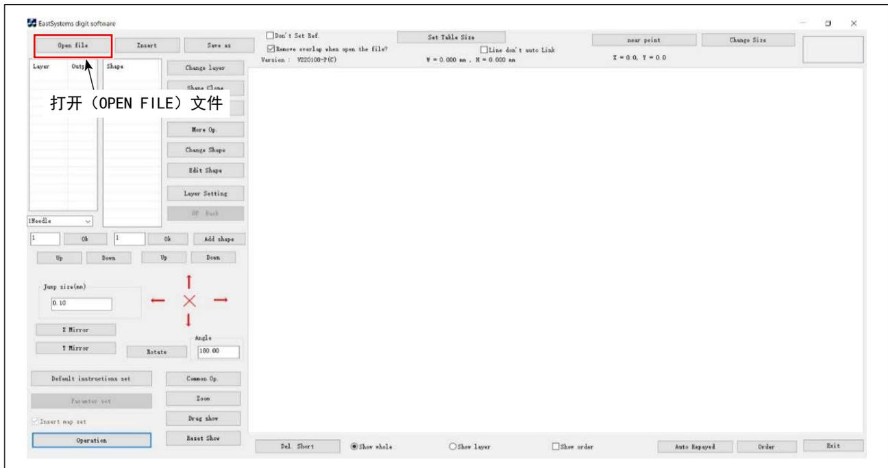
1) 启动可以应对上线夹装置的缝制图案编辑软件，打开要使用的缝制图案。
