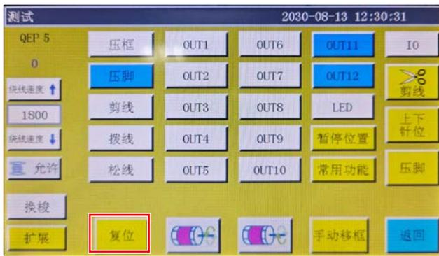
5) 确认无问题后, 按下“重置”按钮, 装置会按顺序先让拨线器返回, 并确认线保持是否关闭。如果不是, 应检查“程序文件”是否正确导入。
