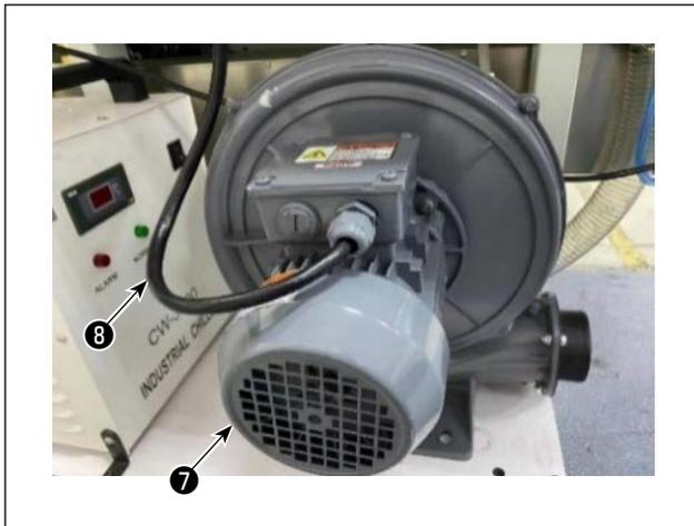
将送风机⑦和转换器①连接到送风机连接电缆⑧上
