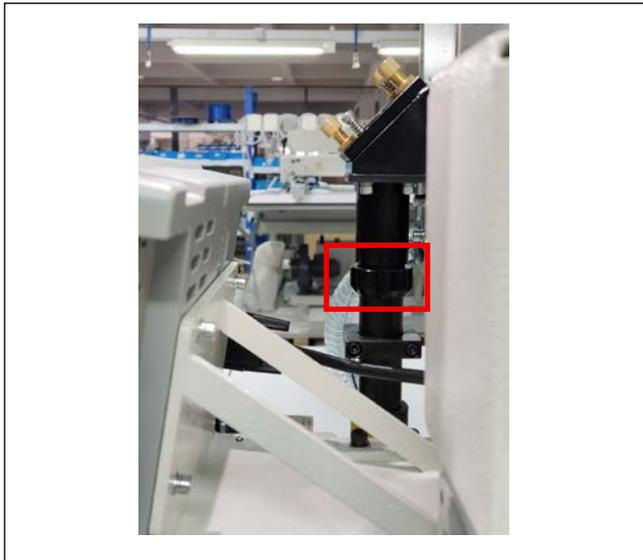
2) 将激光管上方连接处拧松，根据布料厚度不同，调节激光管上下位置即可。
