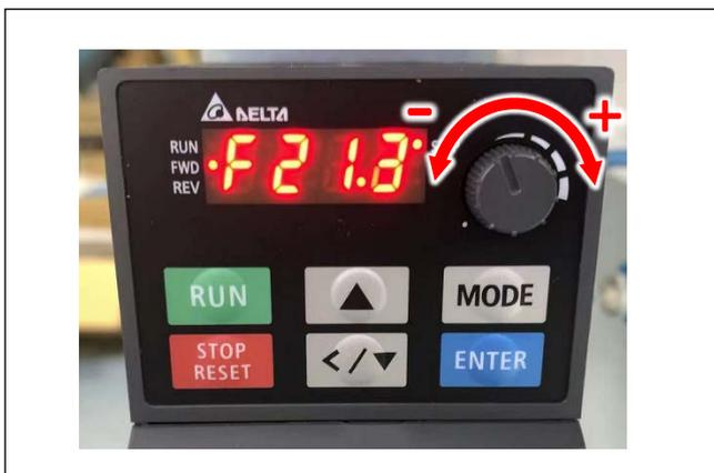
旋转变换器的旋钮，调节风扇风量。调整风力大小直到刚好不会吸住布料。
