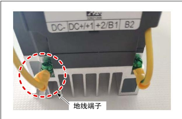
将电缆**13**的绿/黄线连接到地线端子上。
