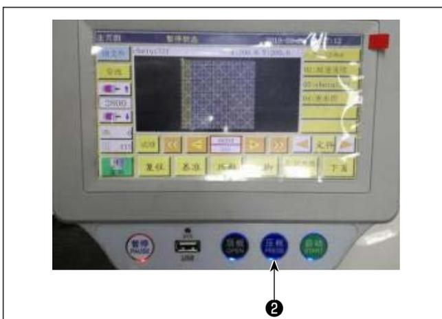
2) 安装模板，朝着 X 方向放入，点击位于显示屏下方的“压框”②。
