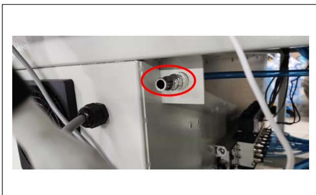
用气管（规格为  $8 \times 5\text{mm}$ ）把气源（气压在  $0.5\text{--}0.55\text{MPa}$ ）压缩空气接入气源进气接口 64。
