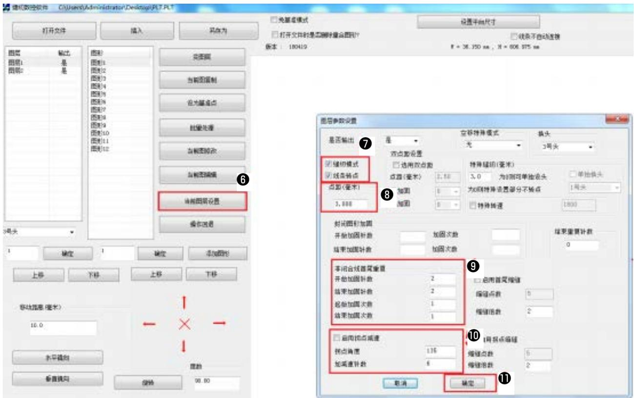
3) 编辑好以后: ⑥ 点击 ‘当前图层设置’ → ⑦ 勾选 ‘缝纫模式’、‘线条转点’ → ⑧ 按工厂要求在这里设置针距 (3cm) ÷ 多少针或者 1 寸 ÷ 多少针再把 = 的数字填入 ( ‘3.000’ ) 的框框 → ⑨ 再按工厂要求在这里设置倒针针数和次数 → ⑩ 如需转角减速把 ‘启用拐点减速’ 勾选按要求修改角度和针数 → ⑪ 点确定
