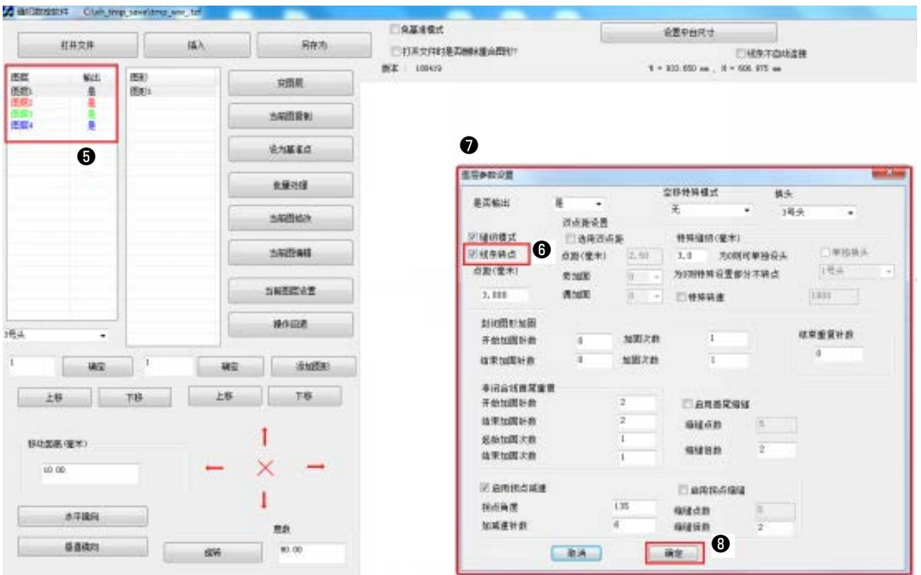
2) 完成后这里会多出一个或几个图层→⑤然后双击图层→⑥勾选线条转折点→⑦设置以下选项（图中的参数是参考参数）→⑧确定（全部图层如上所述设置）
