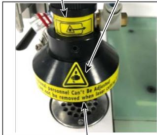
Außer dem professionellen Techniker darf keine andere Person eine Einstellung ausführen. Entfernen Sie die Abdeckung nicht, während der Laser in Betrieb ist.
