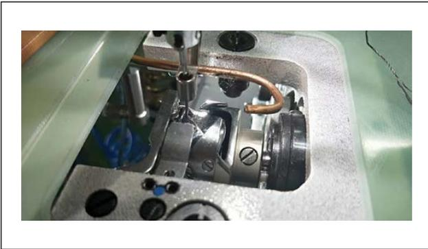
4) Demontieren Sie die Stichplatte. Prüfen Sie die Greifersteuerung.
