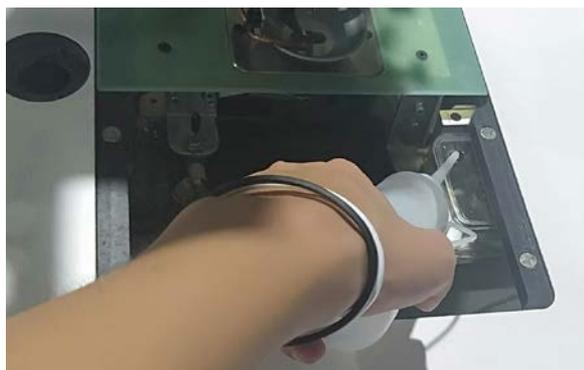
3) Füllen Sie den Öltank mit dem mitgelieferten Öl (oder dem vorgeschriebenen Öl).
