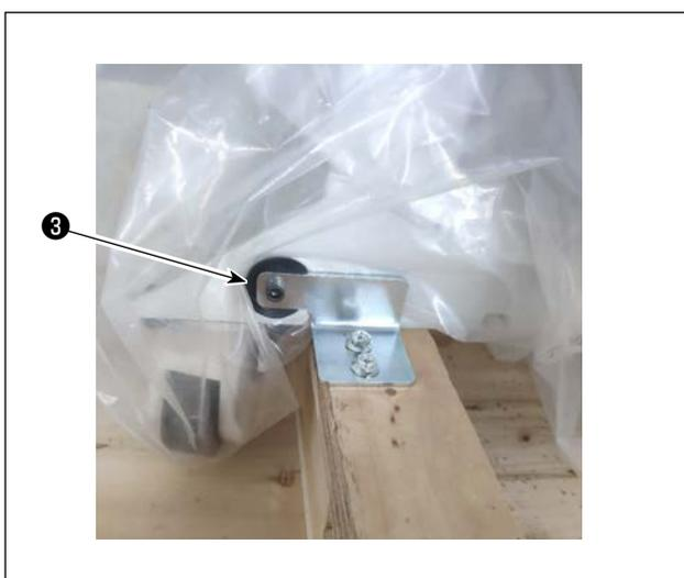
3) Entfernen Sie die Klemmplatten der vorderen und hinteren Laufrollensitze **3** von der Nähmaschine.
