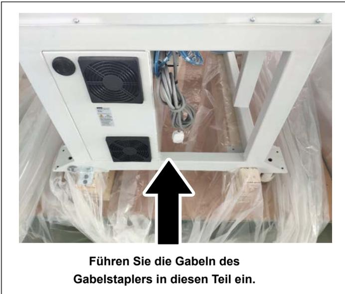
5) Heben Sie die Nähmaschine mit einem Gabelstapler an, um sie zu dem vorgesehenen Ort zu transportieren. (Gewicht der Nähmaschine: 305 kg)
