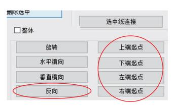
点击"反向"按钮可使所选图形起点反向,即交换起点和终点,交换后的图形如下图(左)所示。
