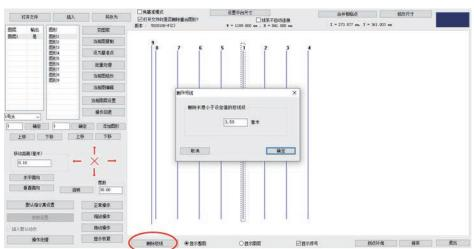
设定短线段的值,点击 确定 即可删除小于设定值的线段。
