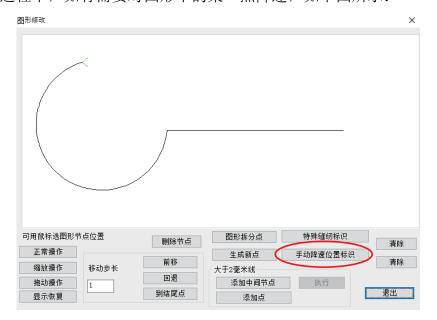
用鼠标双击图形上"降速点 1"的点位,点击 <sup>手动降速位置标识</sup>即可,如下图 所示:
