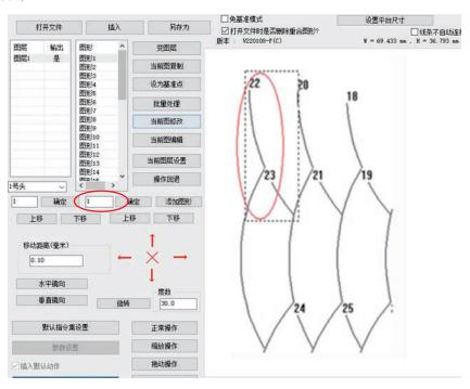
选中"图形 22", 在左侧输入框内将"22"改变成"1", 点击"确定"按钮,则图形 22 变成图形 1,如下图所示:
