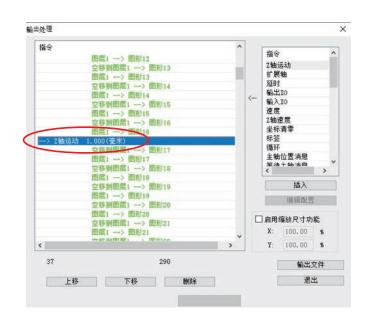
3. 将鼠标移到第一图层缝制结束的位置(主轴停止指令处),选择右侧指令-"延时" "回原点位"、及"上暂停",选择"插入",或双击指令插入。如下图所示:
