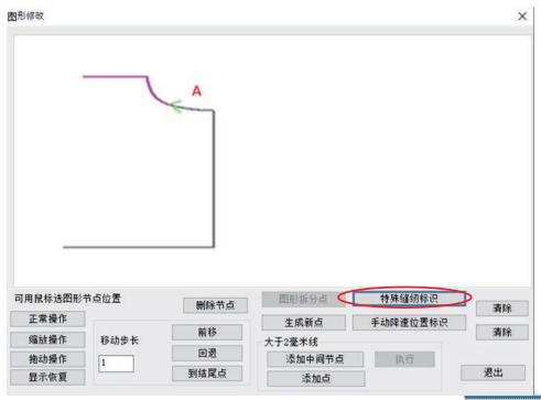
3. 再移动鼠标至"B"点双击(若 B 处无节点,则先添加节点),点击 特殊缝纫标识 则从 A 点至 B 点的特殊针距标识(变粗)生成,如下图所示:
