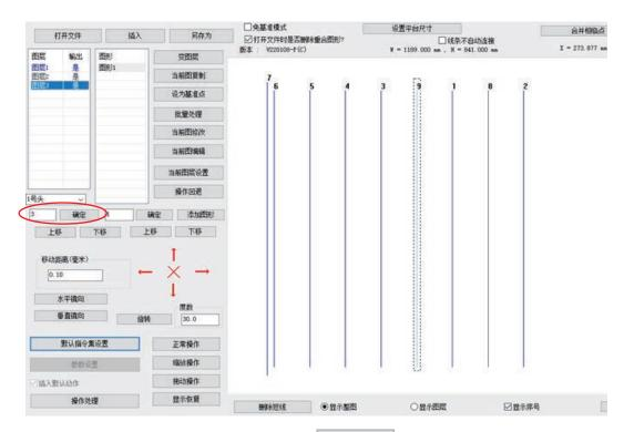
将编辑框中的数字 3 改成数字 1,点击 确定 ,即将图层 3 变为图层 1,如下图所示。
