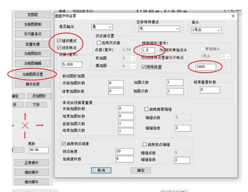
5. 在<sup>特殊缝纫(毫米)</sup> 空格处输入所需针距,或选择<sup>特殊转速</sup> 输入所需的转速,即可。 ※请打开缝纫模式和线条转点。
