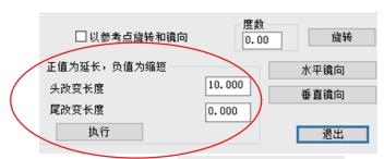
选中需要延长或者缩短的图形,在<sup>可用鼠标选图形节点位置</sup>的编辑框中,输入头尾改变长度的数值,点击"执行",则图形延长或者缩短。
