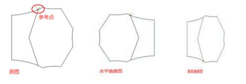
2. 局部变换。如果双击图形节点(出现小红框)以选中参考点,则起始点到参考点以外的图形(如原图 AB 段)将做镜像或旋转运动,默认镜像参考线为通过参考点的水平线或垂直线。
