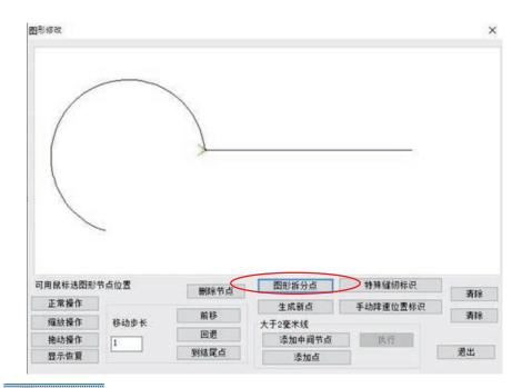
点击 图形拆分点 ,则图形从拆分点处被拆分为两个图形,如下图所示:
