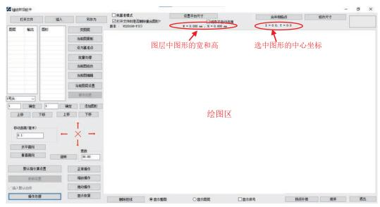
注:图层中图形的宽和高:"宽"指图层中所有图形从最左端点到最右端点在水平(X轴)方向的长度。"高"为从最上端点到最下端点在垂直(Y轴)方向的长度。
