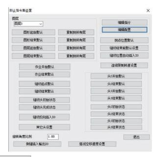
**图形起始默认 ]**: 此处为针对所选定的图层里,在执行每个图形前所需要执行的指令
