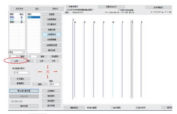
点击一次 上移 按钮,将图层 3 顺序往前移 1,即图层 3 变为图层 2,如图所示
