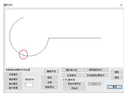
设置后,在"输出指令"中可以看到,当接近手动降速位置时有了"拐点提前减速"-"拐点位置"-"拐点后加速完成" 指令。
