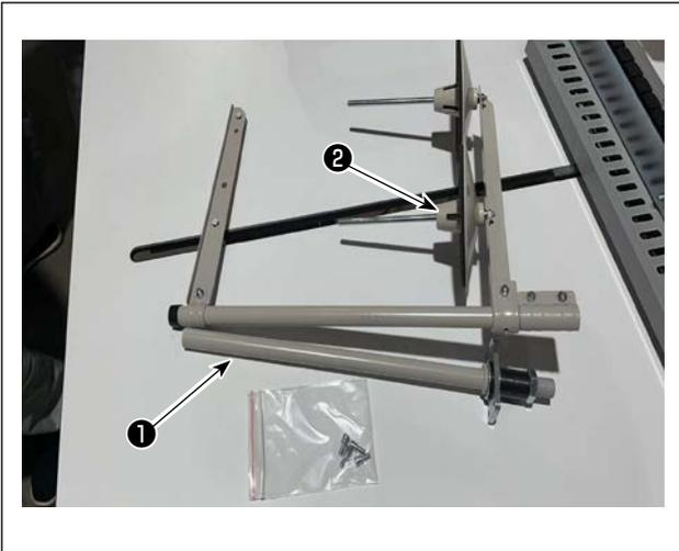
2) 请按照图示，将线架棒（下）**1**安装到机台上。
