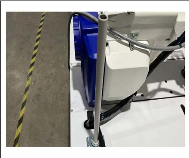
3) 请按照图示，将线卷支撑（组）**2**安装到线架棒（下）**1**上。
