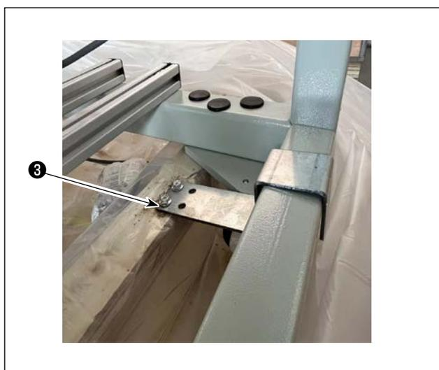
3) 拆下前后缝纫机的脚轮**3**的固定钣金。
