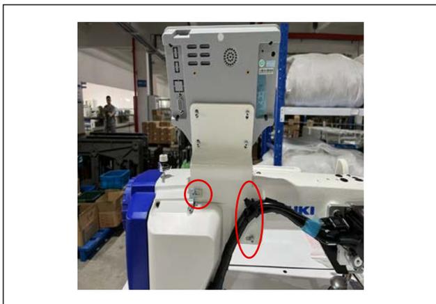
3) 使用①和②将操作面板安装到机械臂上。
