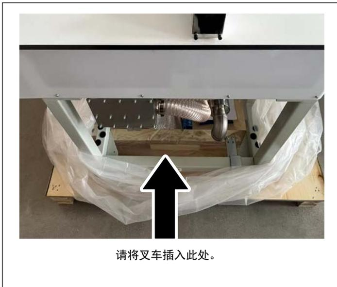
5) 使用叉车，将机器移动至指定位置。（机器重量为 305Kg）
