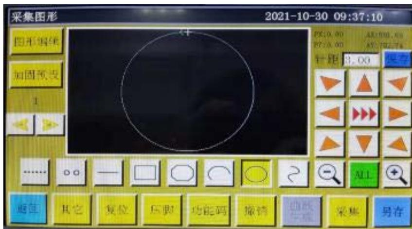
圆形采集时，任意不在同一直线上的3点采集生成一个圆形。加工顺序为：第一点（起始点）>第二点>第三点>第一点（结束点）。
