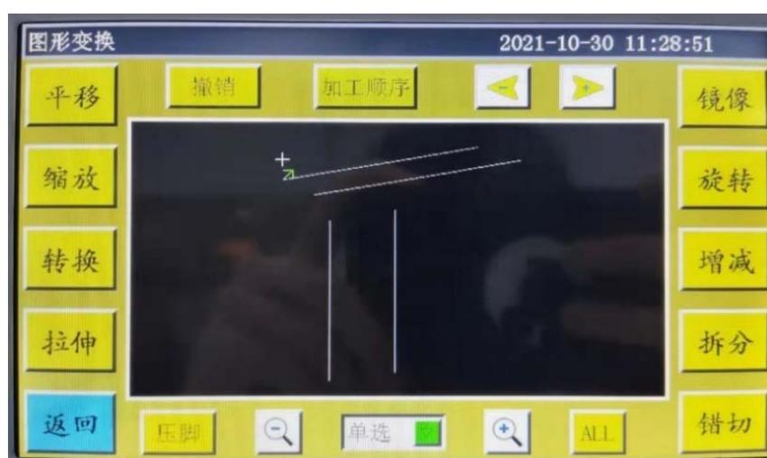
**增减**：在选择的曲线开始或者结束的时候选择增加、或者减少曲线多少毫米。参考「2.2.2 测试界面显示说明」的 **整图增减**。
