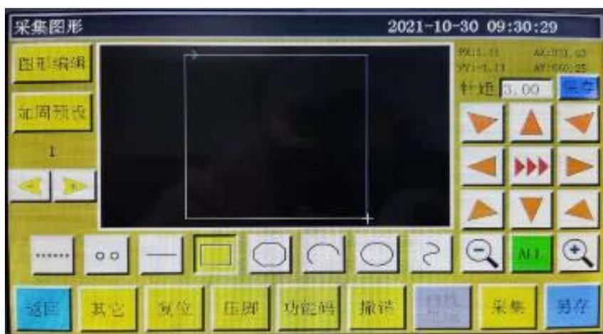
矩形采集时，两个 X, Y 轴坐标都不同的两个点生成一个矩形。
