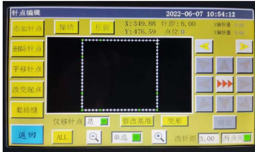
可以选择某个针点进行添加针点、删除针点、平移针点、改变针点等操作。（点绿的点说明已经赋予该点处功能码）
