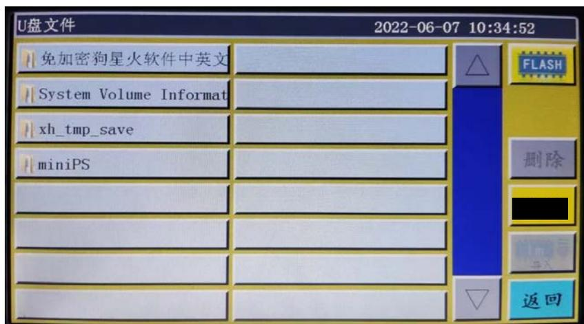
U 盘文件管理支持最多 15 汉字或 30 个字符显示，若通过文件管理进入 U 盘，则默认显示 U 盘根目录下 .klw 与 .slw 格式文件和文件夹，若通过参数文件进入，则默认显示 U 盘根目录下 .xhp 格式文件与文件夹。支持多级文件夹操作，建议文件数量多时采用文件夹的方式进行分类管理。
