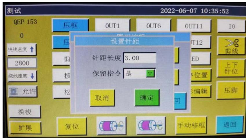
请在间距设定画面按下确认按钮。为了保障在图纸文件中有针棒旋转设定，必须重新进行保存。
