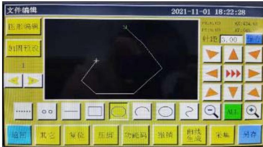
多线段采集时，可以最多连续采集 127 点，以两点直线的方式生成线段。绝对原点或上一个采集段的末尾点为多线段采集的第一点。按键移动光标到需要的位置，按 **采集** 键确定采集点，多次移动并确定采集点，完成后，按 **曲线生成** 键，生成连接各点的多线段。
