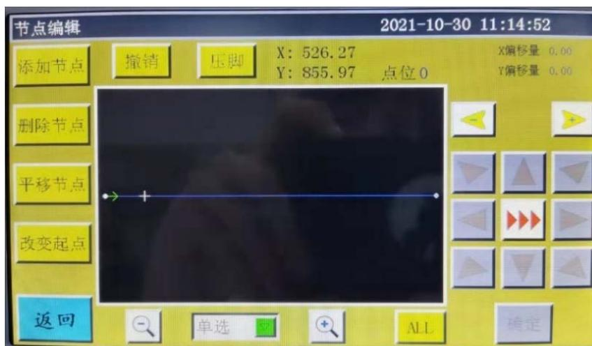
**复制** 复制键：复制一条相对原来曲线 X、Y 有一定偏移量的同样的曲线。
