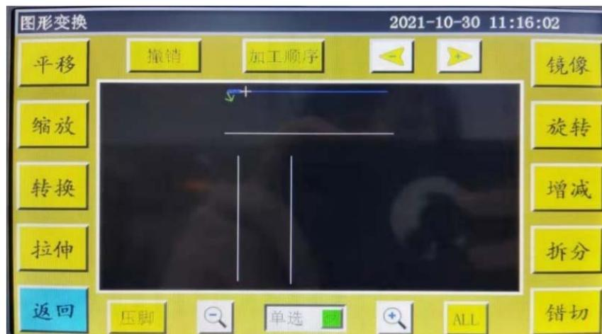
可以通过设置平移、拉伸、缩放、旋转、镜像、增减、错切等的参数来改变或者编辑这个曲线。
