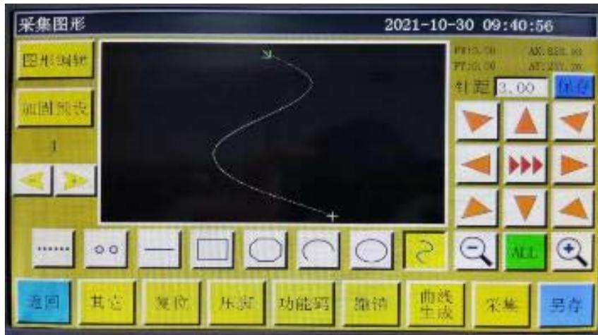
曲线采集时，可以最多连续采集 127 点，以相邻 4 点的弧度方式生成贝塞尔曲线。在转弯时采集点尽量密集，曲线效果才能更好。少于 3 点的采集不能生成曲线。
