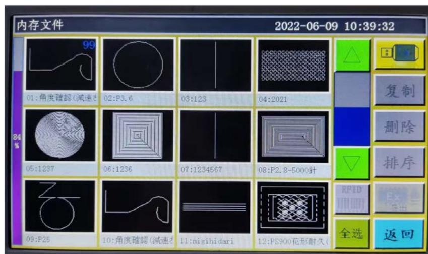
系统内存可存储加工文件最多 999 个，总大小不能超过 128M 总存储空间。文件名支持中英文名字显示，区分大小写，最大支持 15 个汉字或 30 个字符（实际文件名显示出的个数依界面不同而不同）。同时，若加工文件格式不对或者文件被破坏，此处将不会显示预览图。
