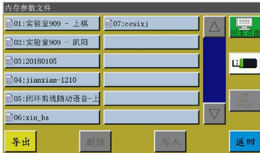
界面中显示系统中已存储参数文件，点击文件名使之变红色，再点击 写入，弹出提示“正在执行,请稍后...”，然后提示“操作成功”并返回主界面说明已使选定的参数生效。“用户参数”、“机械参数”内的设定值和其他隐藏参数都会被此参数文件修改。
