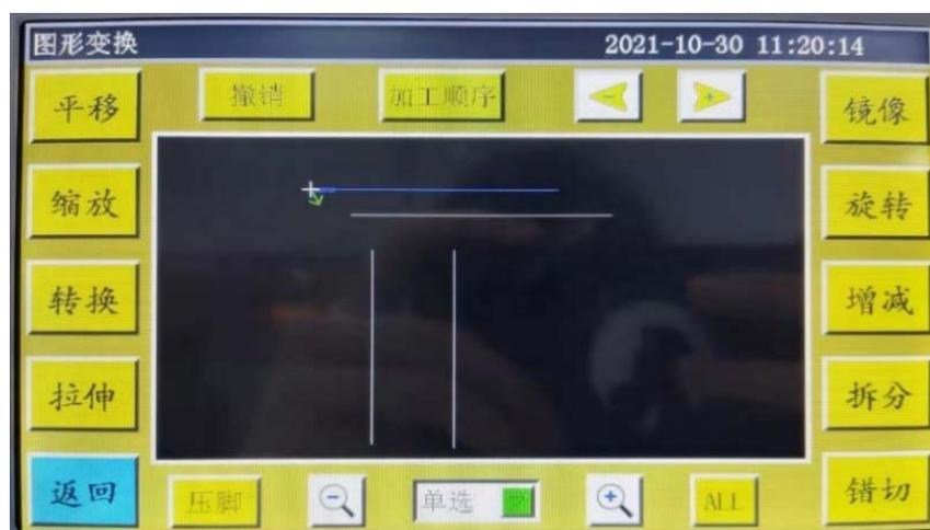
**拉伸** 选择需要操作的图形，设定该曲线的横、纵向比，再点击“确定”则图形按设定的参数进行拉伸。
