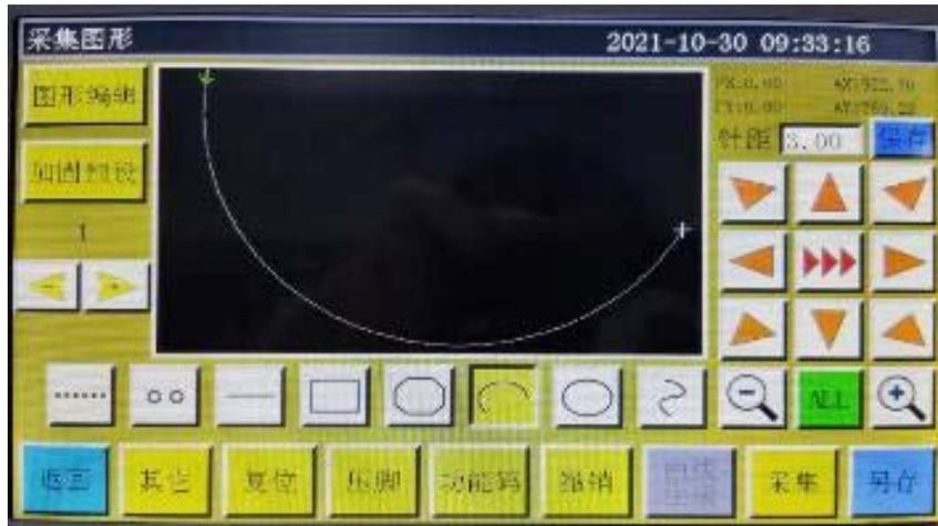
圆弧采集时，任意不在同一直线上的3点采集生成一段圆弧，第一点为圆弧的起点，第二点为圆弧的高度参考点，第三点为圆弧的结束点。
