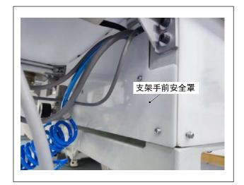
8) 将多余的电线收入支架内,固定支架手前一侧 的安全罩。
