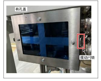
3) 将安全罩安装在过滤箱上,用拨动闩锁(2个)固定。
