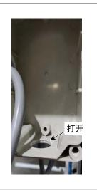
3) 松开缝纫机电源开关安全罩的固定螺丝和电线 密封套的盖子,打开开关安全罩,拉出开关。 在开关盒的下方开孔。
