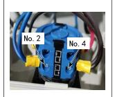
6) 将电源电线放入开关端子台,用螺丝固定。 蓝线是 No. 2,褐线是 No. 4。
