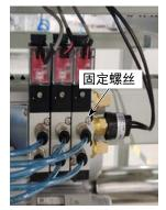
3) 放入橡胶密封圈,固定电磁阀(3)。
