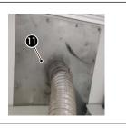
7)将网的板的固定螺丝更换为螺丝(P),使用螺丝 (P)和螺母固定吸引装置安全罩(I)。
