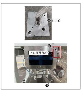
4) 将软管᠑ (1.1m) 插入吸引装置安全罩❶的圆筒部分和过滤盒⑦的上方圆筒部分之深处,然后用管带❶固定。
