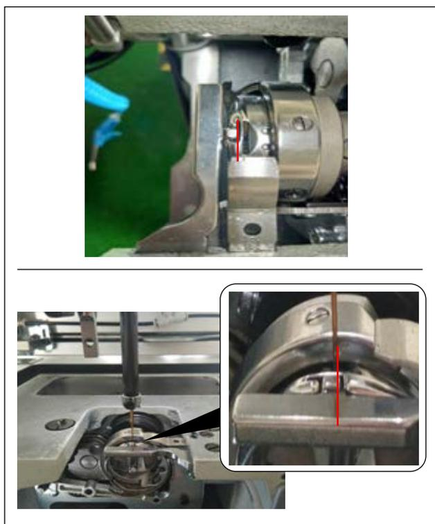
Posizione longitudinale del supporto del crochet interno e dell'ago: L'estremità anteriore dell'ago è allineata con il crochet interno.
