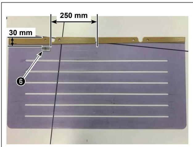
5) Attaccare l'etichetta codice a barre alla cassetta nella posizione che si trova a 250 mm a sinistra rispetto al centro della cassetta (guida di installazione) ed a 30 mm sotto il lato superiore della cassetta.
