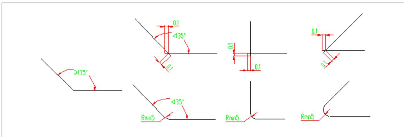
1. Non tagliare un grafico con un R angolo inferiore a 5 (il raggio è inferiore a 5 mm).
