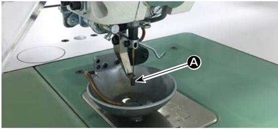
È necessario regolare la corsa (A) del pressore intermedio in modo appropriato poiché ci sarebbe la necessità di prevenire i salti di punto a seconda dello spessore o del tipo di materiale.
