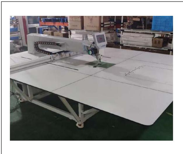
1) Ispezionare l'orizzontalità della macchina per cucire.
