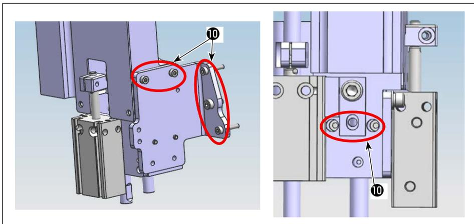
5) Allentare le viti 10 di fissaggio (sette pezzi) dell'unità di controlama.
