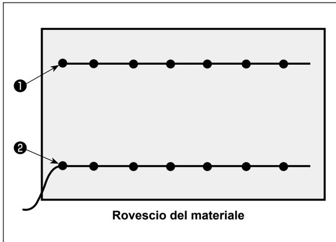
È possibile impostare la posizione dell'estremità del filo dell'ago all'inizio della cucitura sul lato superiore ❶ o inferiore ❷ del materiale. Commutare l'impostazione della funzione dello scartafilo tra ON e OFF in base a queste due condizioni della posizione dell'estremità del filo dell'ago.
