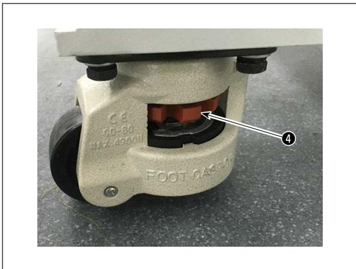
7) Ruotando le rotelle ④, assicurarsi che la macchina per cucire sia posizionata orizzontalmente sulle forche del carrello elevatore. Mantenere la macchina per cucire sulle forche in modo tale che non scuoti.
