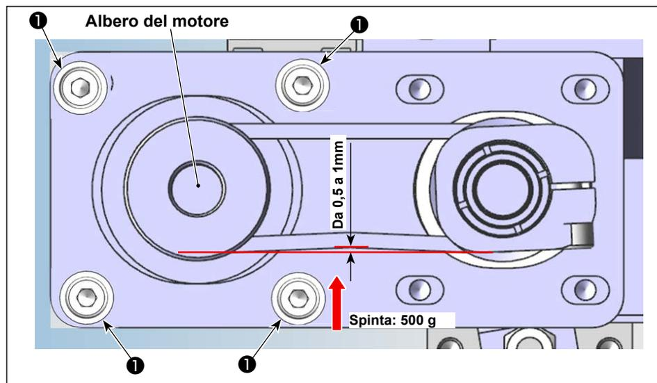
Misurare la tensione della cinghia con un misuratore di spinta e un calibro a corsoio. Se la tensione della cinghia non rientra nelle specifiche, allentare le viti ❶ di fissaggio del motore (quattro pezzi) e regolare la posizione del motore in modo appropriato.
