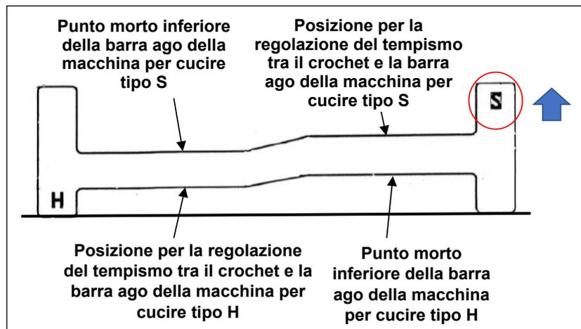
Regolare il tempismo del crochet in base al tipo di cucitura (tipo S/tipo H) della macchina per cucire.
