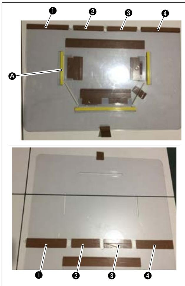
Lavorare a macchina i template superiore e inferiore in base alla progettazione.
