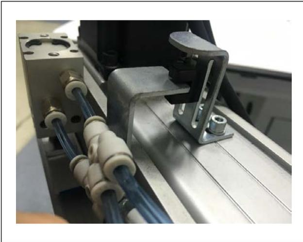
5) Ispezionare la distanza lasciata tra il sensore di rilevamento dell'origine del trasporto X e la piastra di rilevamento.
