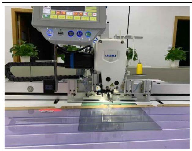
2) Posizionare l'etichetta codice a barre nella cassetta proprio sotto il lettore di codici a barre. Quando il lettore di codici a barre riconosce il codice a barre, il lettore di codici a barre emette un segnale acustico.
