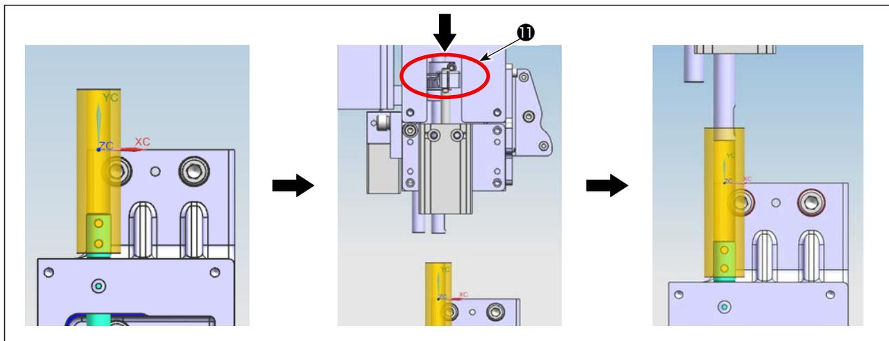
6) Incastrare la dima della boccola sull'albero del coltello mobile. Spingere verso il basso il collegamento 11 dell'unità di controlama per inserire l'albero della controlama nella dima della boccola.
