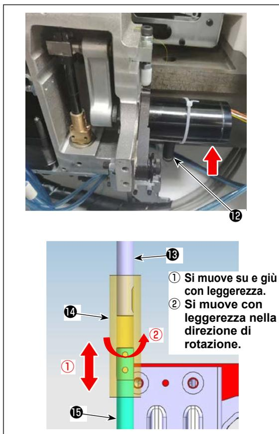
7) Rimuovere la molla 12 di riposizionamento del coltello mobile. Sollevare il motore di azionamento.
