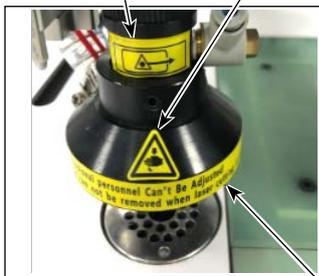
No se permite el ajuste por ninguna otra persona que no sea el ingeniero profesional. No retire la cubierta mientras la luz láser esté en funcionamiento.
