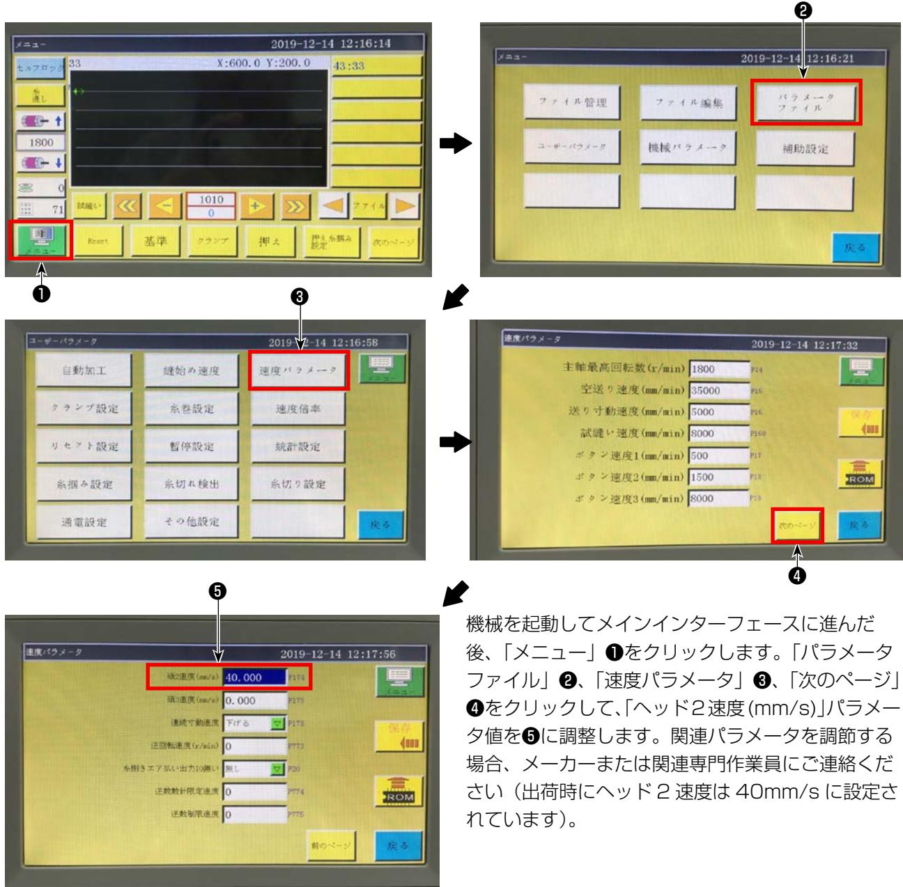
機械を起動してメインインターフェースに進んだ後、「メニュー」①をクリックします。「パラメータファイル」②、「速度パラメータ」③、「次のページ」④をクリックして、「ヘッド2速度(mm/s)」パラメータ値を⑤に調整します。関連パラメータを調節する場合、メーカーまたは関連専門作業員にご連絡ください（出荷時にヘッド2速度は 40mm/s に設定されています）。
