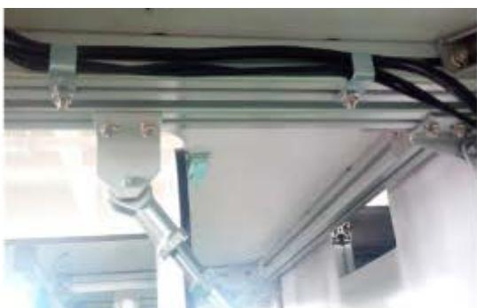
1) 電源スイッチプレートは、前テーブル（右）のアルミフレームに十字ねじ **A**2 個で固定します。
