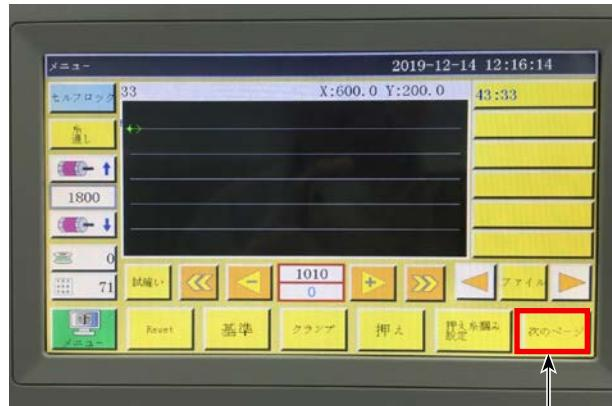
機械を起動してメインインターフェースに進んだ後、「次のページ」①をクリックします。「手動送り」②、「ヘッドオフセット」の③、「ヘッド2」をクリックして、X軸方向に98.5、Y軸方向に54.5を入力します（カット位置や縫製位置のいずれに応じて調整します。X軸方向への移動数値が小さいほど、メスの位置は左寄りになります）。Y軸方向への移動数値が小さいほど、メスの位置に向かい合う縫製位置がワーク位置に近づきます）。
