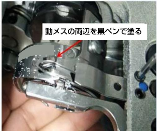
3) 動メスの刃の 5mm の所に黒ペンで印を入れ、固定メス圧力調整ねじ③で固定メスの圧力を調節します。
