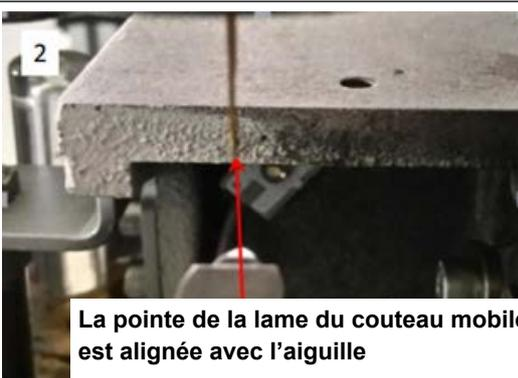
La pointe de la lame du couteau mobile est alignée avec l'aiguille
