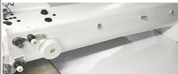
2) Faire passer le fil comme illustré sur la figure. Enfin, tirer l'extrémité du fil de 50 à 60 mm à travers l'œillet de l'aiguille.
