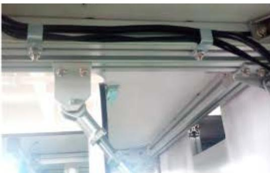
1) Fixer la plaque de l'interrupteur d'alimentation au cadre en aluminium de la table avant (droite) avec deux vis cruciformes **A**.
