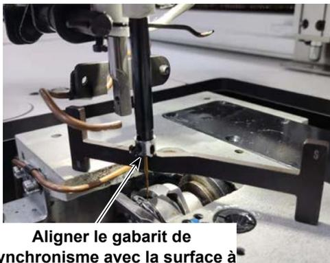
Aligner le gabarit de synchronisme avec la surface à l'extrémité de la barre à aiguille.
