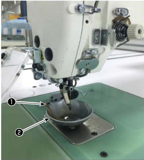
El tubo de soplado ❶ sopla aire para soplar la extensión del extremo del hilo desde la aguja para traerla por debajo del disco prensatelas ❷ al inicio del cosido, controlando la válvula solenoide del sistema eléctrico.
