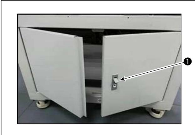
1) Libere el bloqueo **1** de la puerta en la parte trasera o en el lado de la máquina de coser para abrir la puerta.
