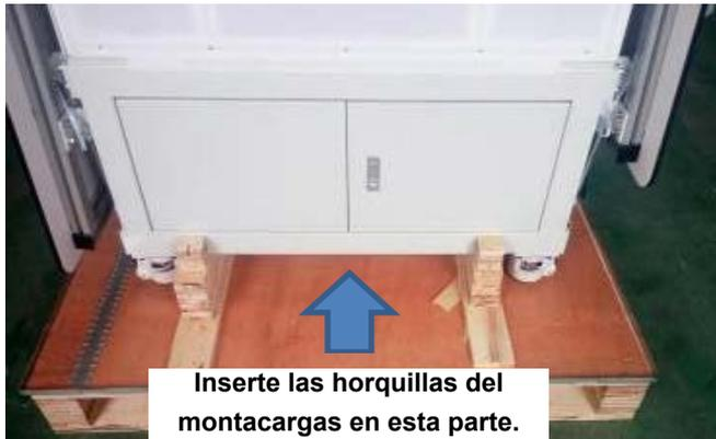
Inserte las horquillas del montacargas en esta parte.
