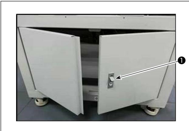
1) Lösen Sie die Verriegelung **1** der Tür auf der Rückseite oder Seitenfläche der Nähmaschine, um die Tür zu öffnen.
