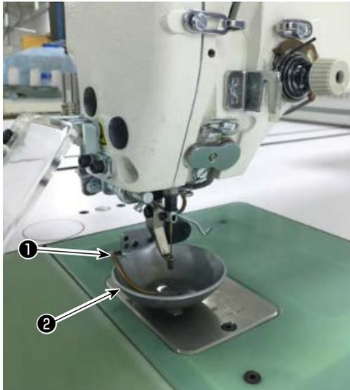
Durch Steuern des Magnetventils des elektrischen Systems bläst das Hochblasrohr ① Luft, um das von der Nadel überhängende Fadenende am Nahtanfang hochzublasen und unter den Scheibenpresser ② zu bringen.
