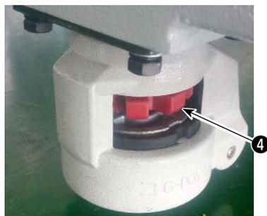
7) Drehen Sie die Laufrollen, um sicherzustellen, dass die Nähmaschine horizontal auf den Gabeln des Gabelstaplers ruht. Halten Sie die Nähmaschine so auf den Gabeln, dass sie nicht klappert. Drehen Sie das rote Pad 4, um das Befestigungspad einzustellen.
