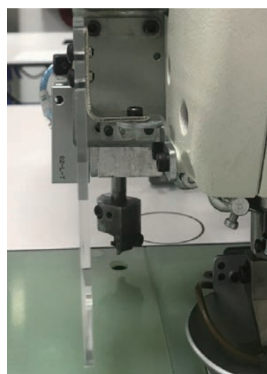
Tấm gắn tấm bảo vệ mắt sau khi thay thế
