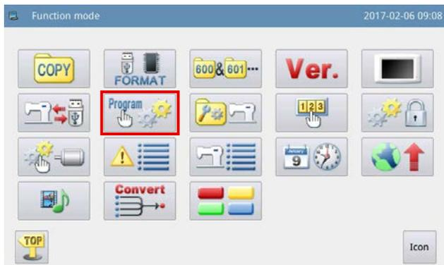
1) Appuyer sur la touche
