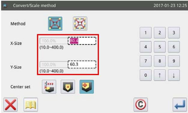
6) Si le réglage de l'agrandissement/réduction change de dimensions, la cadre en pointillé changera de dimensions pour permettre l'agrandissement/la réduction du programme de couture en spécifiant les dimensions.
