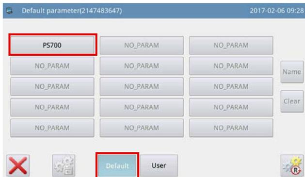
2) Sélectionner le modèle à réinitialiser et appuyer sur la touche
