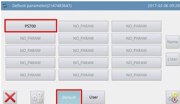
2) Wählen Sie das zu initialisierende Modell aus, und drücken Sie die Taste
