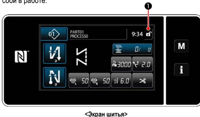
Простая блокировка активируется удержанием на экране шитья клавиши
