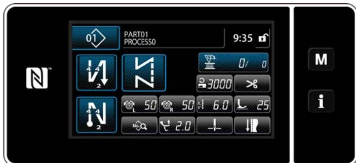
Доступны три различных типа счетчика: счетчик шпульной нити, швейный счетчик и счетчик времени шага.
