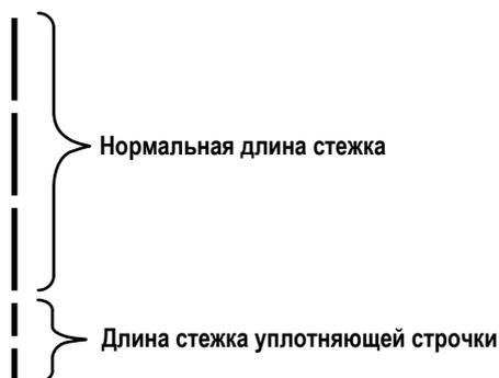
В случае выполнения после нитеобрезки плотной строчки (плотная строчка помещается в положение ON) , могут быть изменены заданные значения длины стежка и плотной строчки. Надайте те заданные значения подходящим образом в зависимости от швейного изделия.
