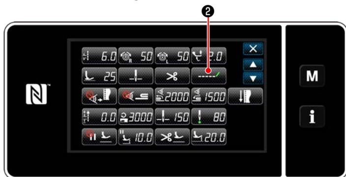
2) ② を押し、「S055 残短」を表示させます。
