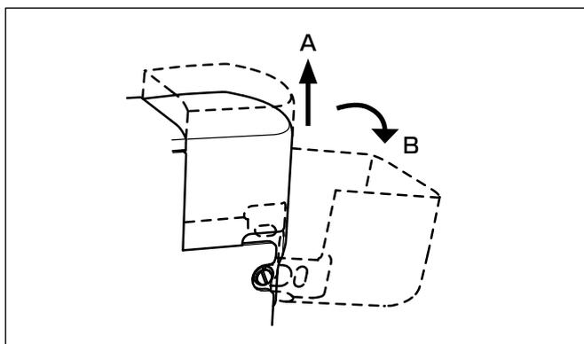
釜カバーは、一度 **A** 方向に引き上げてから、**B** 方向に動かし、開きます。2 本針ミシンの場合、左右共に同じ開き方になります。
