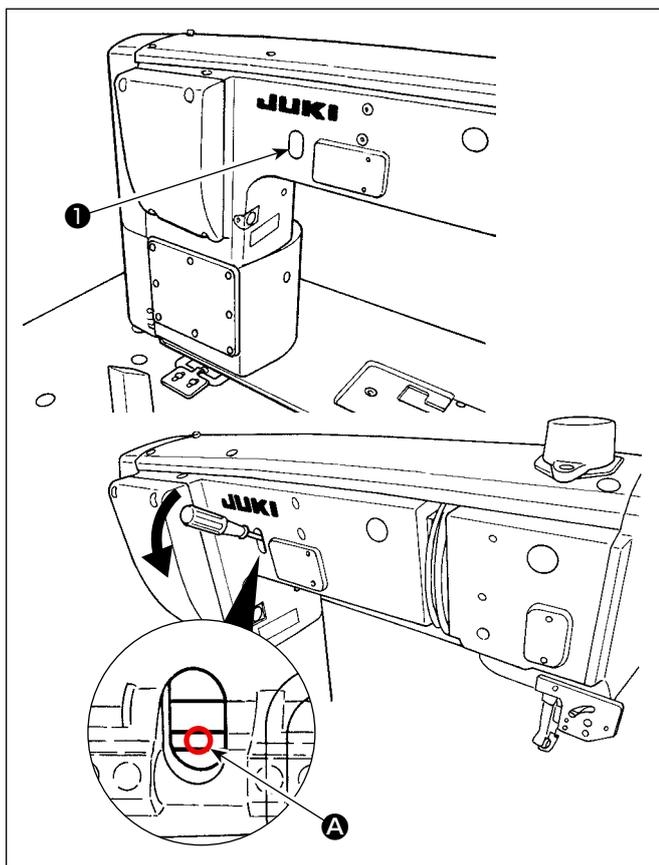
停電等の非常時に押えを上げる必要がある場合は、ゴムキャップ①を外し、軸と軸の間②にドライバー等を差し込み、ドライバー等を押し下げることによって押えを上げます。
