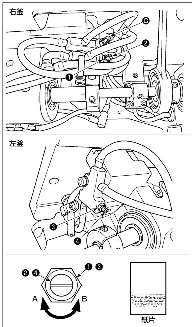
1) 右釜の油量調節は、ナット①をゆるめ、油量調節ねじ②で行います。
