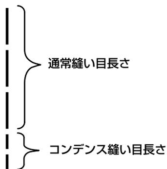
糸切りコンデンス (コンデンス ON の時) の時、コンデンス縫い目長さおよび針数は、設定値変更が可能です。縫製アイテムによって、調整してください。
