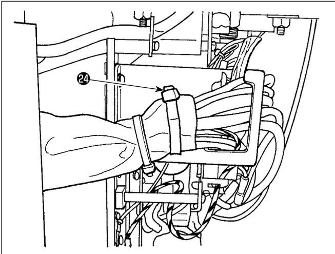
ボタンチューブ端部もボックスの固定バンド<sup>24</sup>で固定します。
