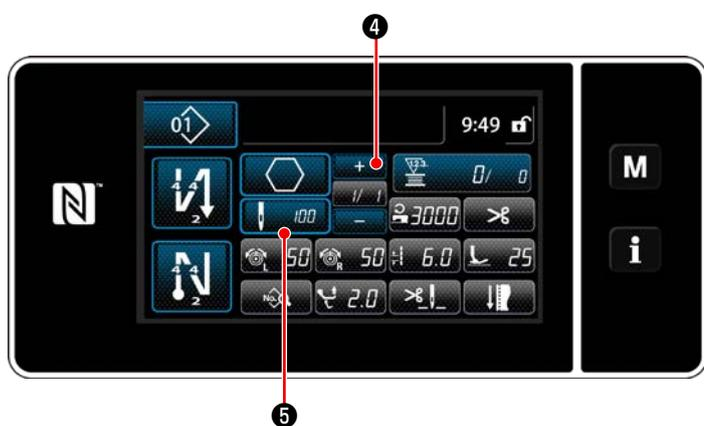
**+** **4** を押すと、現在のステップのティーチング内容を確定します。**100** **5** を押すと、ステップの針数入力画面に移行します。登録できるステップがない場合は操作できません。ステップの最後 (最終針) まで縫った後、糸切り操作をして、ティーチング内容を確定します。
