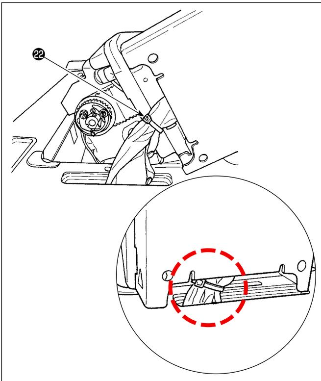
頭部を倒した状態でボタンチューブを頭部カバーに入るところまで引き上げます。
