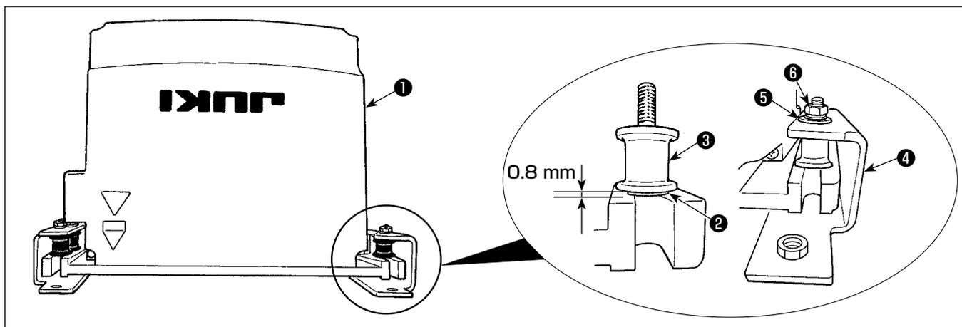
1) 電装ボックス①に、歯付座金②、防振ゴム③を固定します。(4ヶ所)
