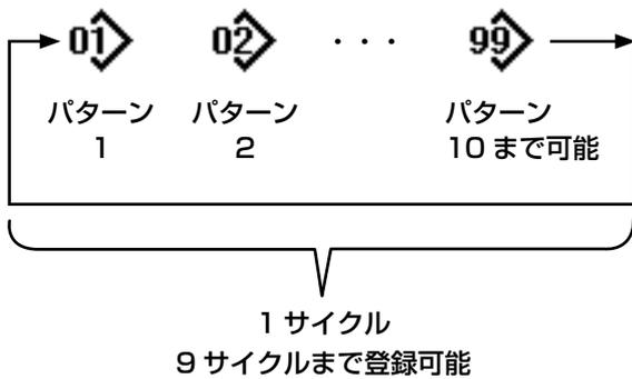
複数の縫製パターンを組み合わせ、ひとつのサイクル縫いのパターンとして縫製できます。ひとつのサイクル縫いパターンには最大 10 パターンが入力できます。製品の縫い工程で、異なるパターンが規則的に続く場合に便利です。
