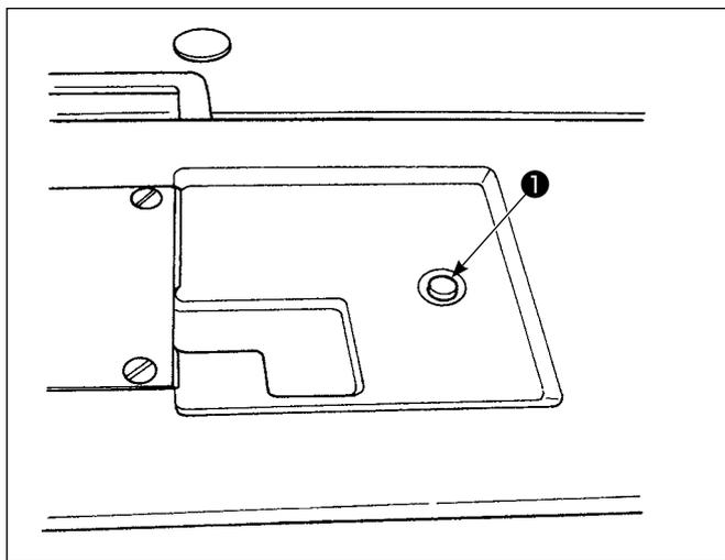
縫製中に、釜等に無理な力が加わると、安全装置が働きます。この時、はずみ車を回しても釜は回転しません。安全装置が働いた時は、その原因を取り除き、次のように元通りに復帰させます。
