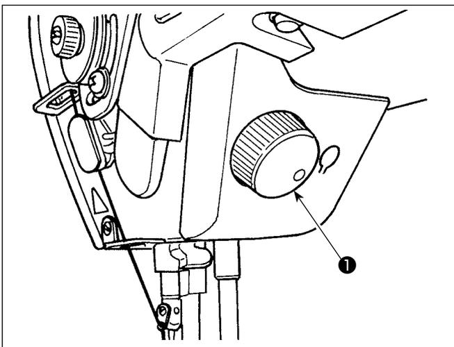
ジョグダイヤル①を押すと、半針補正スイッチの機能が働きます。スイッチの機能は変更することができます。（[\[4-11. カスタムスイッチについて\]](#) p.33 参照）
