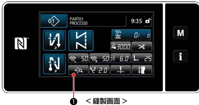
フリー縫い、定寸縫い、重ね縫い選択時の縫製画面で
