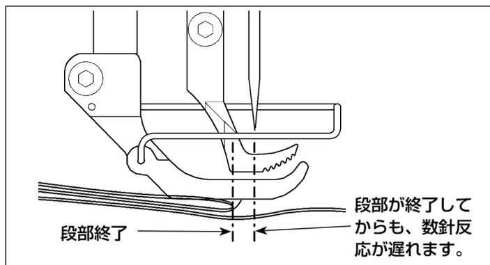
段部を降るとき、段部検知し平部縫製条件に戻りますが、縫製条件によっては、反応までに遅れが生じます。この場合は、段部の針数設定をすることで、対応できます。
