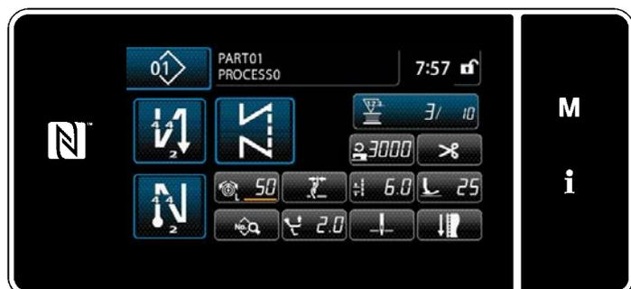
Wenn Sie beginnen, die Nadelfadenspannung entsprechend der Spulenfadenrestmenge zu korrigieren, erscheint eine Linie unter dem eingestellten Wert der Fadenspannungs-Einstelltaste.
