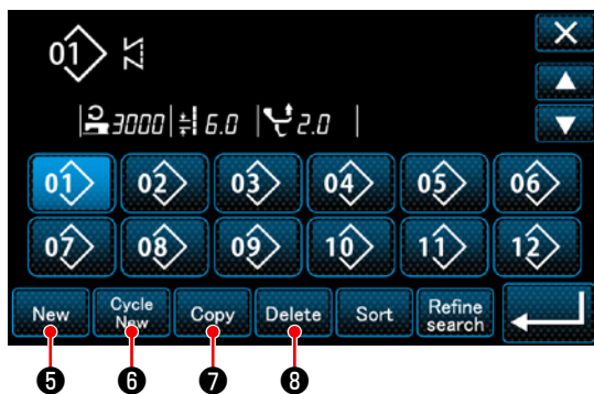
Pantalla de lista de patrones: En orden numérico (Modo de personal de mantenimiento)
